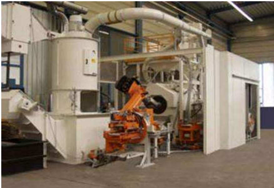
تصویر شماره ۲۳: دستگاه بلاستینگ مدرن مجهز به ربات
