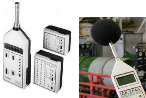
شکل شماره ۶ - تصویر تراز سنج صوت و آنالیزور فرکانس
